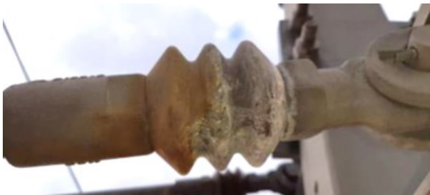
Abbildung 1: Schäden Gießharz-Isolatoren ELISA (Siemens)
