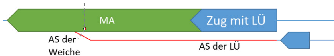
Abb. 63: Spezialfall Abhängigkeit zweier Flankenschutz-Gefahrabschnitte (AS) von derselben Fahrzeugbewegung Quelle: [Eigene Darstellung]
