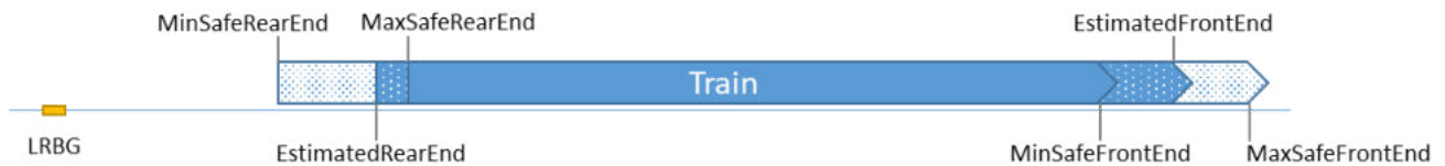
Abb. 2: ETCS-Fahrzeugpositionsangaben in Bezug zum letzten Ortungsreferenzpunkt (LRBG) [Eigene Darstellung nach dem ETCS-Regelwerk [ERA 2016]]
