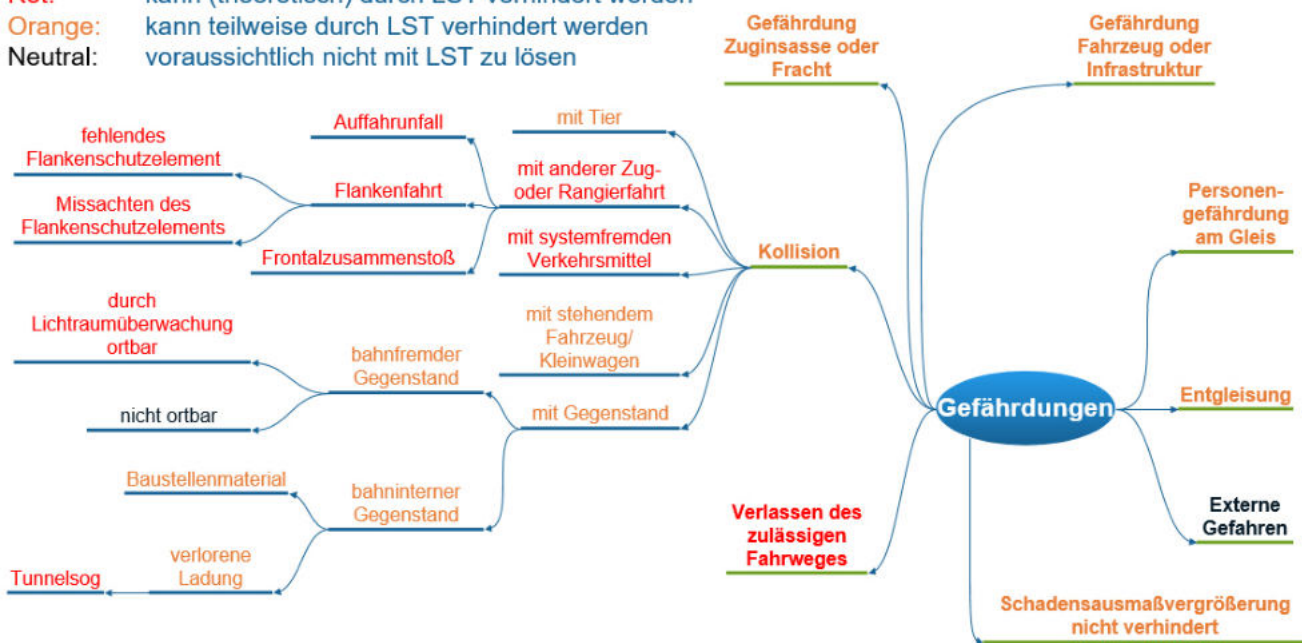
Abb. 38: Auszug aus der bzgl. Relevanz klassifizierten Gefährdungsübersicht (Hauptgruppe Kollision aufgeklappt) [Eigene Darstellung]
