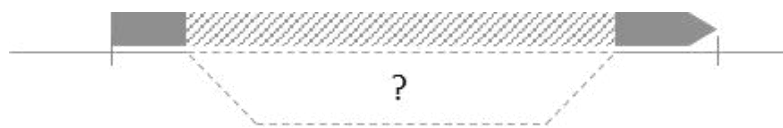
Abb. 55: Unklarheit über Ausdehnung der Fahrzeugbewegung bei unklarem Laufweg [Eigene Darstellung]
