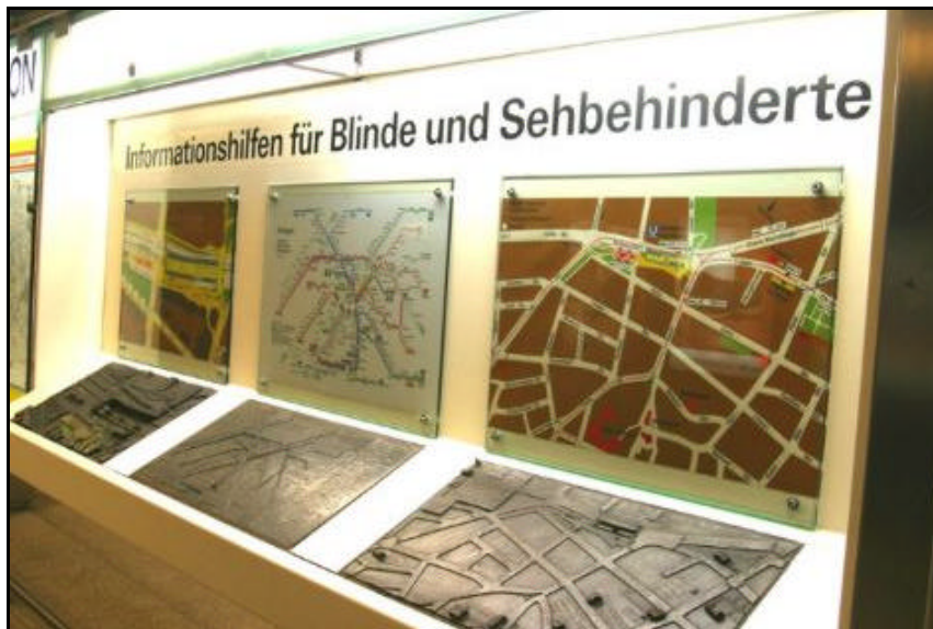
Bild 7: Reliefplatten innerhalb der Station Stuttgart Degerloch [53]
