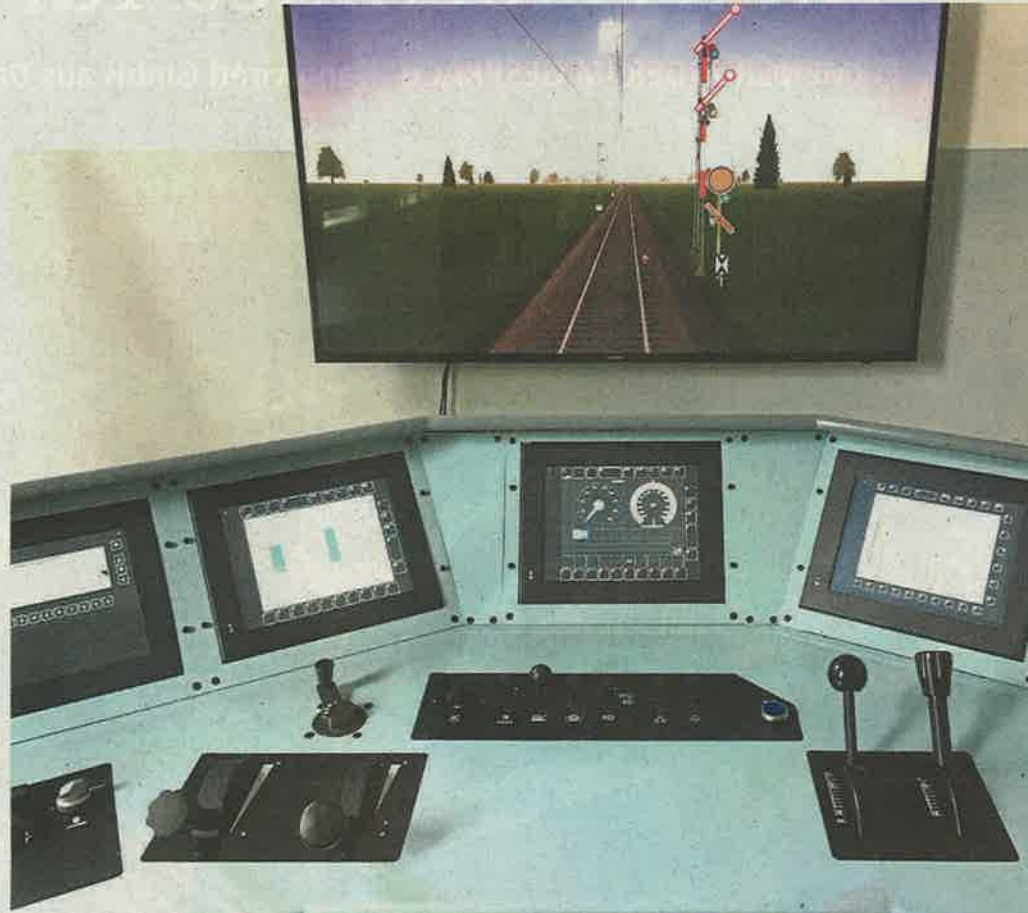
Der neue Fahr Simulator im Eisenbahnbetriebsfeld dient der Weiterbildung der Bahnmitarbeiter, aber auch der Forschung an der Technischen Universität Darmstadt. Foto: J.N. Dornbach/AKA Bahn
